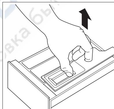
3. После снятия дозатора с помощью маленькой щетки прочистите отсек, в котором он находился, тщательно удалив все остатки моющих средств из его углублений вверху и внизу.
