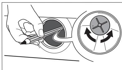
8. Установите фильтр на место, аккуратно вставив его по направляющим. Плотно закрутите крышку насоса, вращая ее по часовой стрелке.
