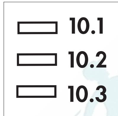
После нажатия на кнопку **8** загорается индикатор СТИРКА (**10.1**). Машина работает. При выборе программы сушки индикатор СУШКА (**10.2**) загорается и остается включенным на всем протяжении этапа сушки.
