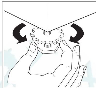
После того, как прибор будет выровнен, затяните контргайки.
