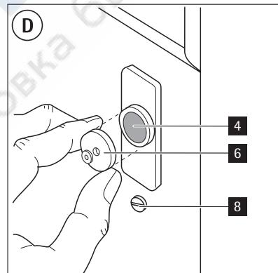
Если требуется перевесить дверцу, чтобы она открывалась слева направо, перенесите на другую сторону накладки (7), магнит (4) и накладку (5) (Рис. В и Е). Установите ответную часть магнита (6) и петли (1), как описано выше.
